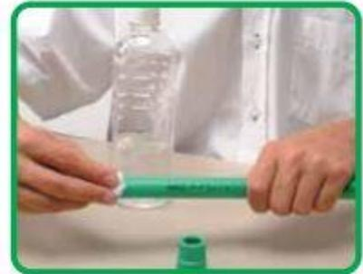
Limpia la punta del tubo y el interior de su accesorio con un trapo humedecido, antes de realizar cada termofusión.
