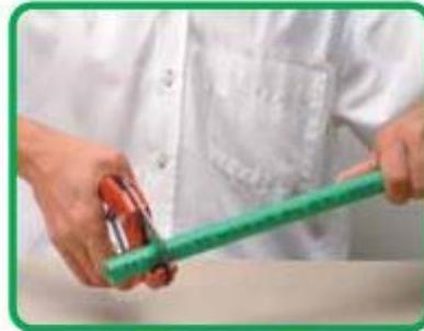
Cortar el tubo en ángulo recto con una tijera corta tubo, u otra herramienta de corte que asegure el corte sin rebabas.
