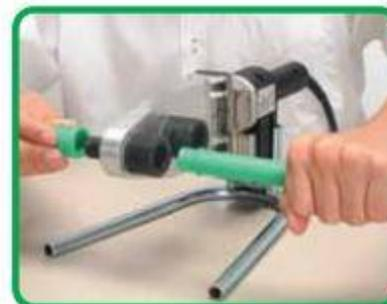
Introducir simultáneamente el tubo y la conexión en los dados, manteniéndolos en posición perpendicular a la plancha del termofusor.
