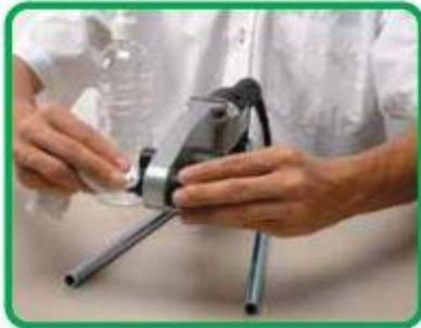
Limpia los dados del termofusor con un paño humedo, con la máquina en frío y sin conectar.
