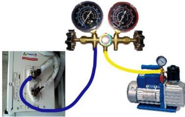
5. Nuevamente encender la bomba de vacío e inmediatamente abrir la válvula de baja del juego de manómetros, dejarlo por lo menos 30 min (Depende de la capacidad de la bomba de vacío)
