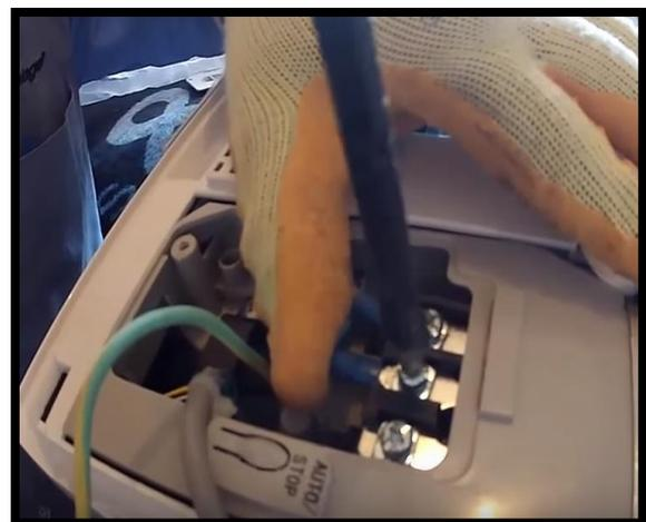
4. Retirado de tuercas de seguridad (Precaución, el equipo viene previamente presurizado).
