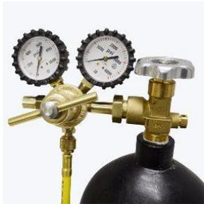
4.\_En un recipiente colocar una esponja y colocarla en la tubería destapada tubería más gruesa (baja), proceder a abrir la válvula del tanque de nitrógeno y realizar pequeñas presurizaciones con el dedo, para que salgan las impurezas del equipo.
