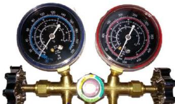
7. Cerrar válvula de baja del juego de manómetros, apagar bomba de vacío, y prócer a abrir la válvula de baja del mini-split con una llave Allen, después abrir la línea de alta, dejar que el refrigerante recorra el sistema y poner el equipo a funcionar.
