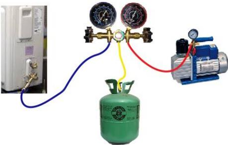
4.\_Una vez que al equipo se le haya cargado alrededor de la mitad de refrigerante que marca la placa de datos, se procede a abrir la válvula del mini-split de baja y de alta.
