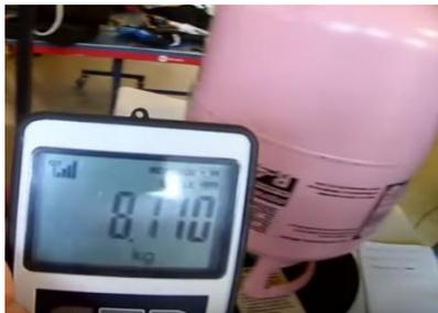
5.\_Se procede a encender el equipo y se continua con el proceso de abrir y cerrar las válvulas del juego de manómetro hasta alcanzar los gramos que el equipo requiere para su funcionamiento.
