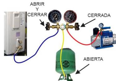
3.\_Proceder a abrir la válvula de la bolla de refrigerante y después abrir y cerrar 2 o 3 veces el juego de manómetros por unos 5 segundos para cargar refrigerante al equipo.
