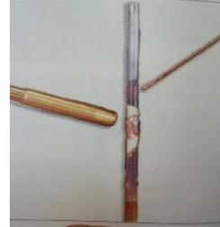
5.\_Una vez derretida la pasta, alejar la flama un poco y colocar la soldadura hasta que se derrita formando un anillo alrededor del tubo.
